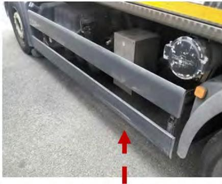
Exemple de barre anti-encastrement inférieure en bon état même si présence de quelques rayures
