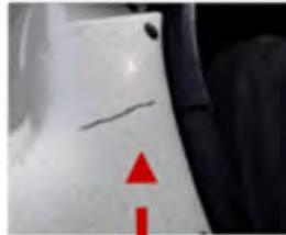
Aile de roue fissurée
