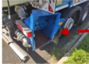
Exemples de coffres et rangements présentant des déformations et ou des éléments manquants
