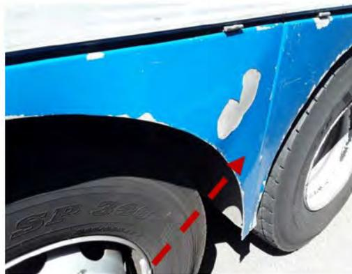
Aile de roue côté droit fissurée
