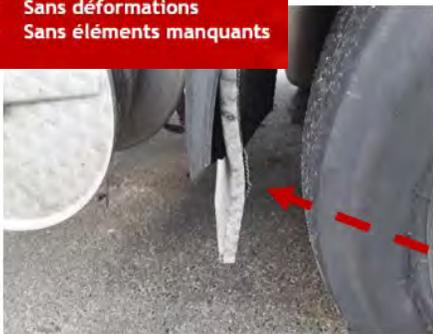
Bavette d'aile de roue 3ème essieu déchirée
