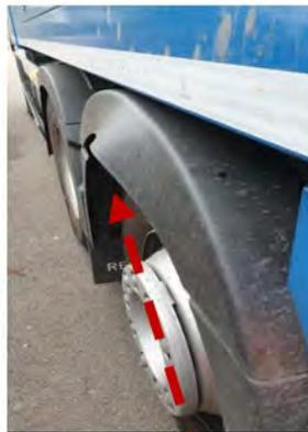
Ailes de roues déformées
