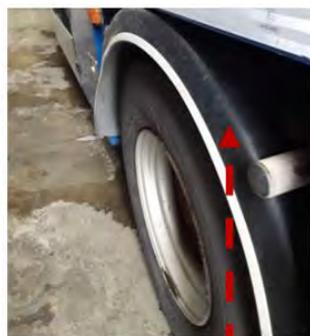
Exemple d'une aile de roue côté gauche en bon état
